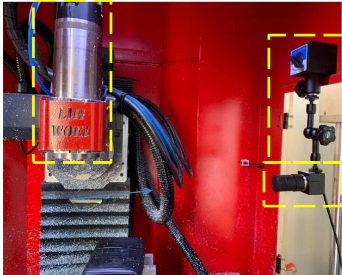
利用磁性底座的相機支架將相機架設在刀具主軸的側邊，同時調整鏡頭的變焦距離以便我們取得適當的視野位置。
