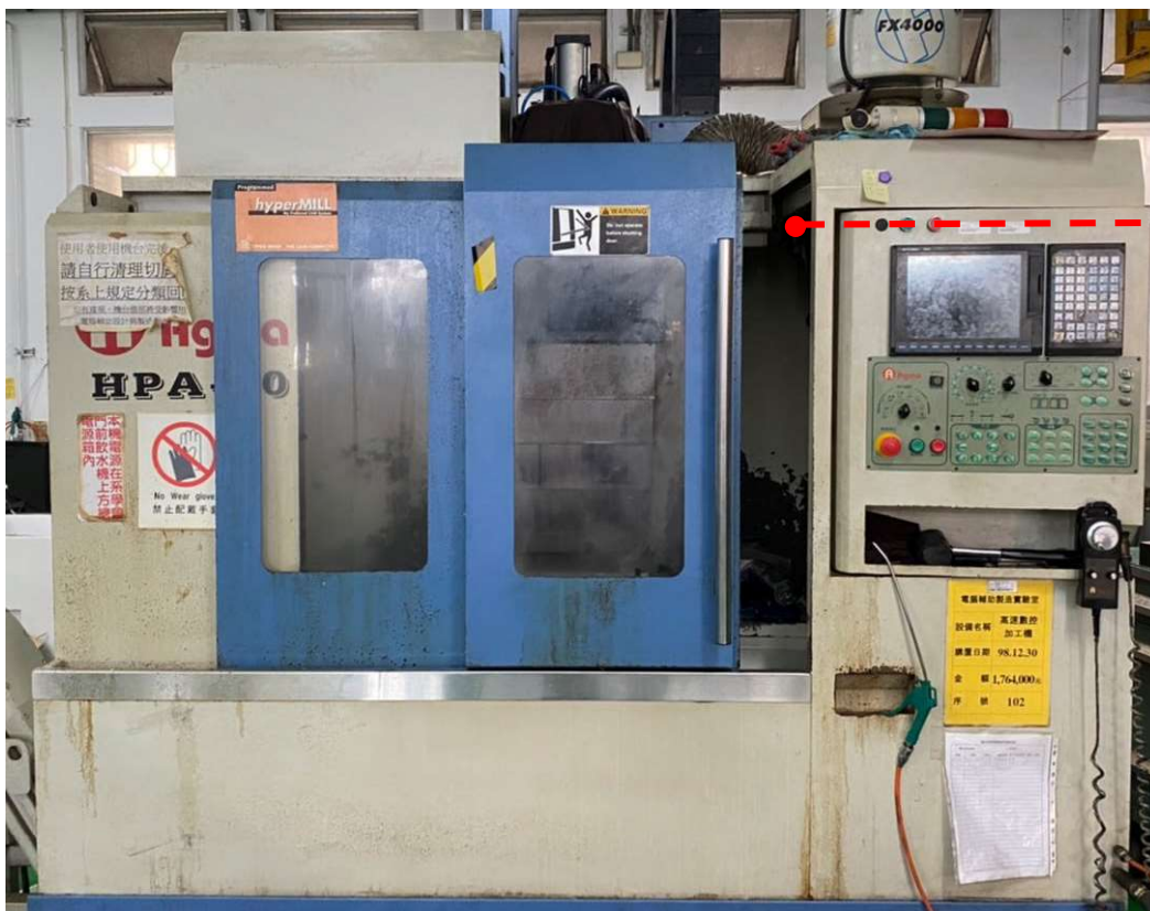
3軸CNC銑床(Mitsubishi M70控制器)
