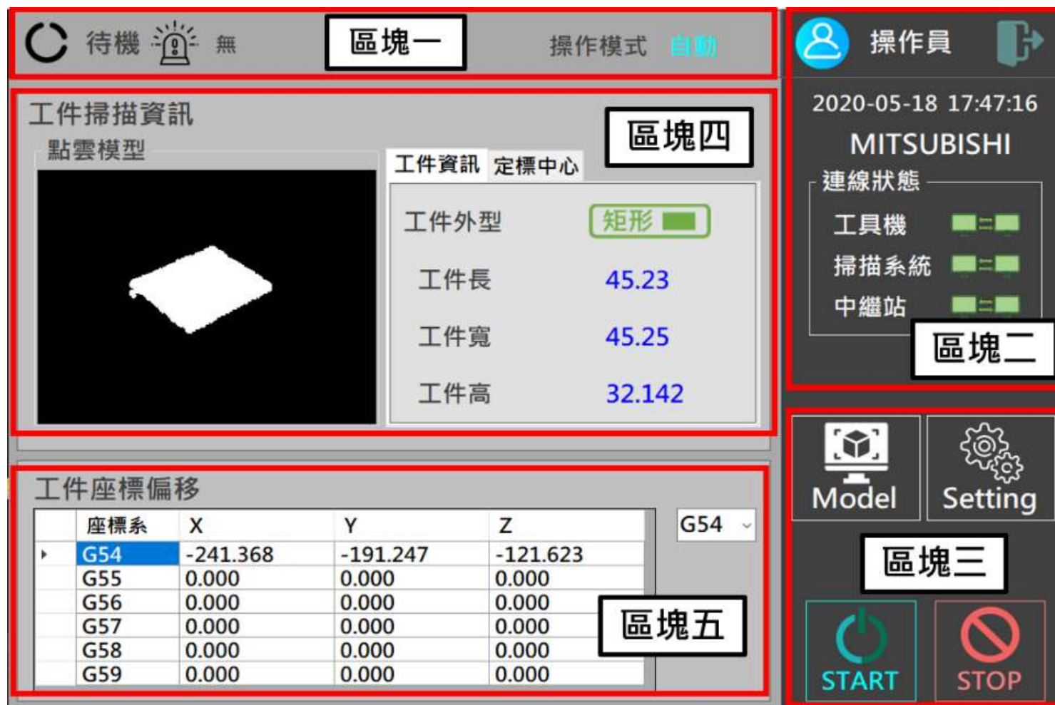
▲ 智能化3D視覺輔助工具機工件座標定位系統介面
