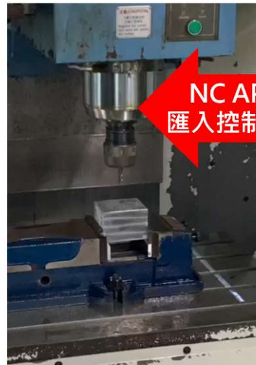
控制器執行G54達到自動基準點定位之功能
